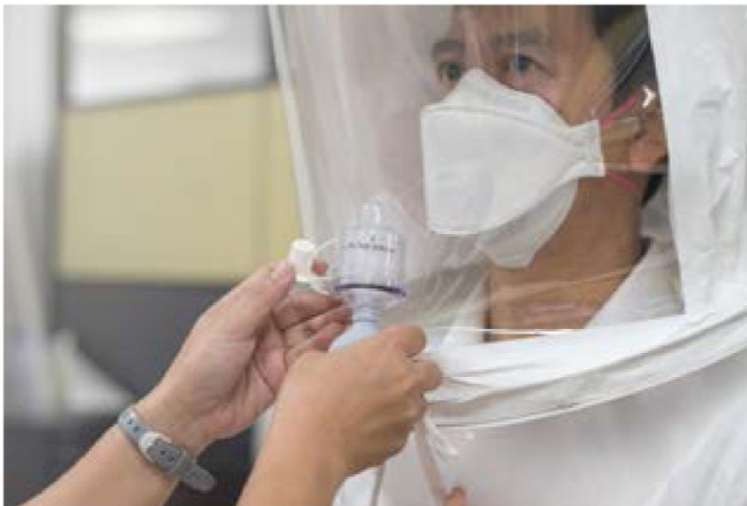
Рис. 4.4. Перевірка щільності прилягання респіратора з використанням досліджуваного капюшона
