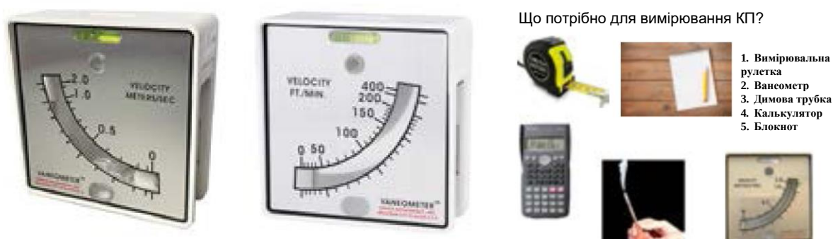
Рис. 3.11. Інструменти для вимірювання КП (включаючи приклад ванеометра з різними блоками)
