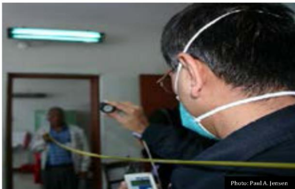
Рис. 3.7. Вимірювання ефективності UVC254 та безпеки світильників на рівні очей за допомогою радіометра
