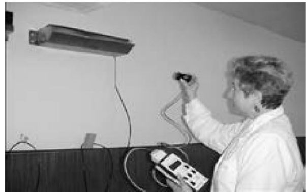
Рис. 3.7. Вимірювання ефективності UVC254 та безпеки світильників на рівні очей за допомогою радіометра
