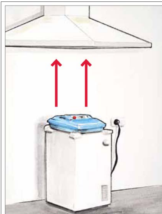
Канал витяжної вентиляції над автоклавом
