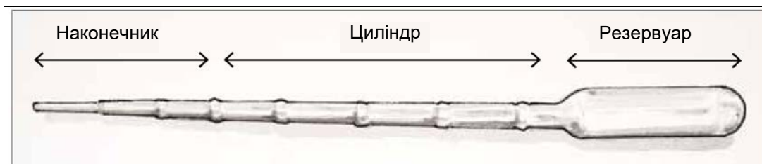
Основні структури одноразової піпетки
